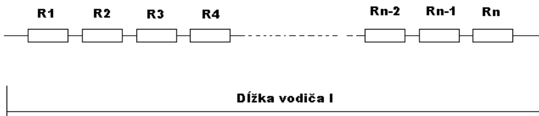
Obrázok 2 – Elektrické vedenie, ako obvod s rozloženými parametrami
