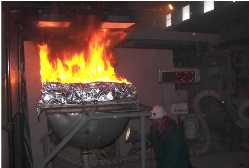
Obr. 7 Skúšobná vzorka strešného plášt'a s asfaltovou krytinou podľa STN P ENV 1187 (t4) po vzplanutí krytiny – v danom prípade kritérium prieniku plameňa nebolo dosiahnuté po dobu trvania skúšky 60 minút a tento model strešného plášt'a bol vyhodnotený ako vyhovujúci. (foto: M. Smolka, Rockwool)
