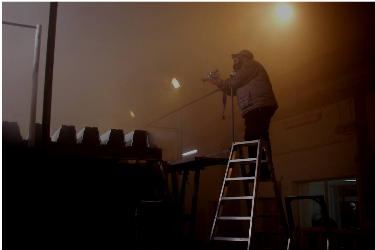
Obr. 9 Zadymené prostredie pri skúške požiarnej odolnosti strechy s tepelnou izoláciou z penového plastu (foto: M. Smolka, Rockwool)
