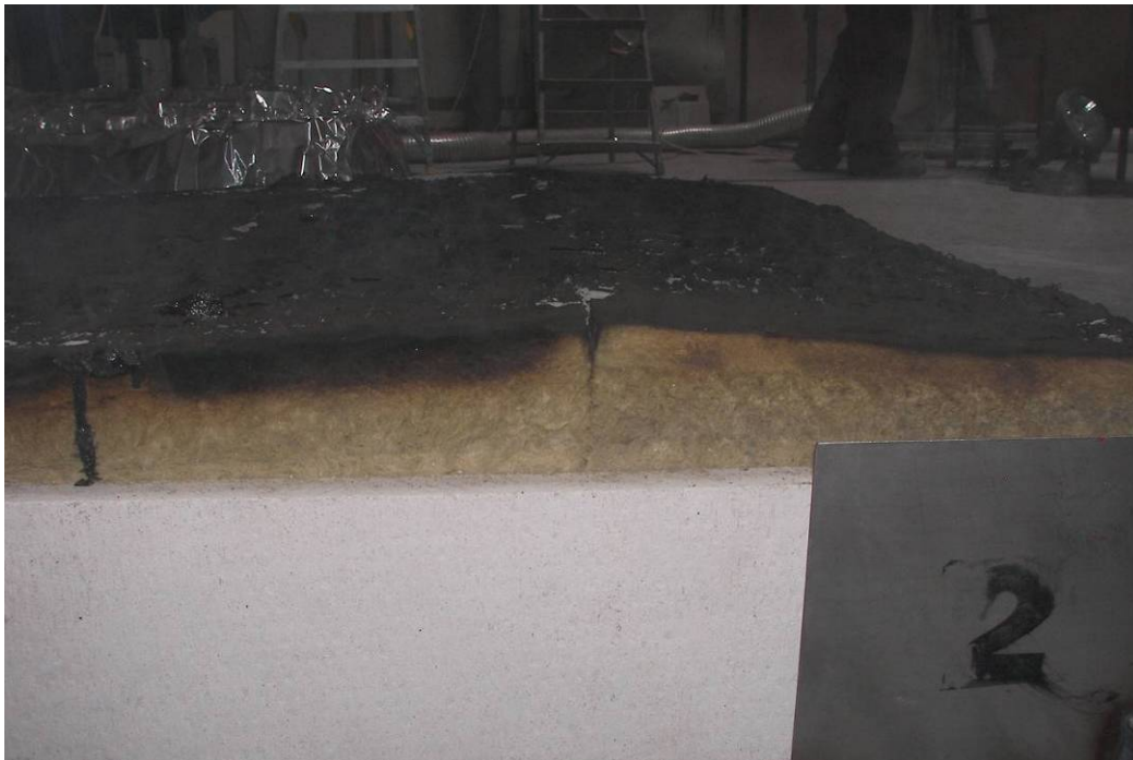
Obr. 8 Skúšobná vzorka strešného plášt'a s kvalitnou asfaltovou krytinou a nehorľavou tepelnou izoláciou z kamennej vlny skúšaná podľa STN P ENV 1187 (t4) po ukončení testu (sklon 0^\circ ) – napriek intenzívnemu horeniu povrchu zostala skladba strešného plášt'a nepoškodená (foto: M. Smolka, Rockwool).
