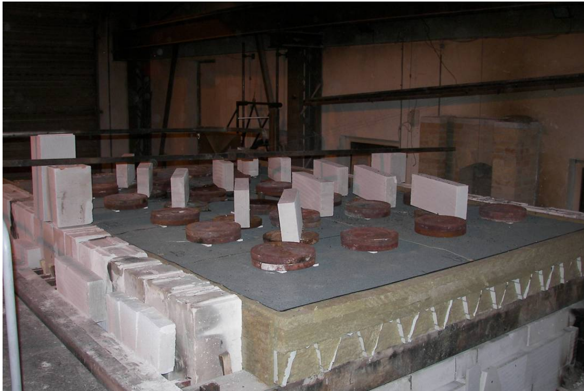
Obr. 18 Vzorka strechy pred skúškou požiarnej odolnosti (foto: M. Smolka, Rockwool)
